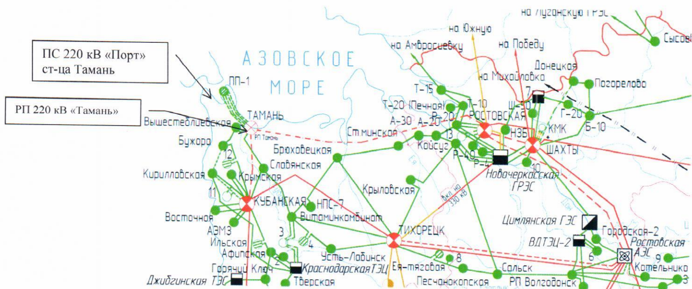
Карта-схема размещения линий электропередачи, подстанций напряжением 220 кВ и выше и электростанций энергосистемы Краснодарского края и Республики Адыгея на 2014-2020 гг.
