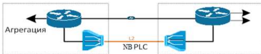
Рисунок 9. Участок сети с использованием PLC
