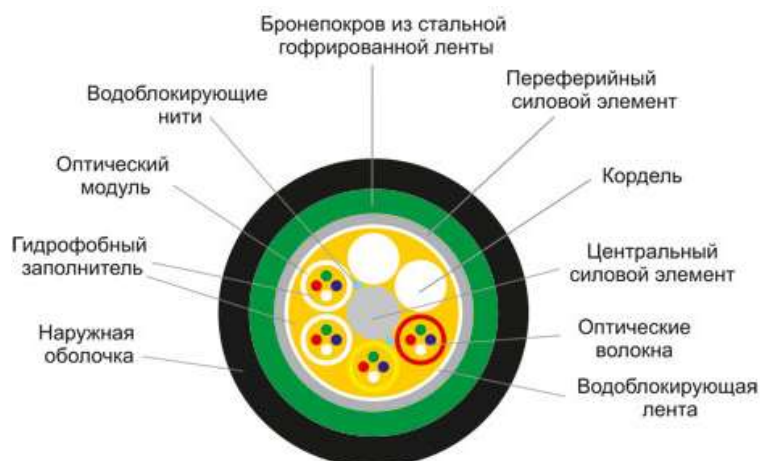
Рисунок 12. Пример конструкции ВОК для прокладки в зданиях
